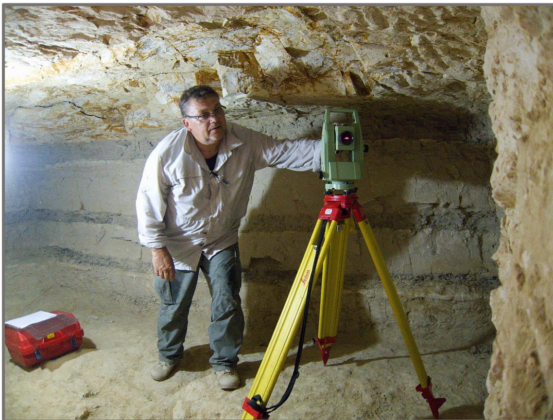
Vladimír Brůna provádí měření v pohřební komoře s geodetickou totální stanicí Leica TCR307
