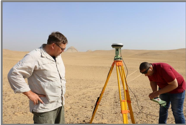
Zaměření geodetického bodu pomocí GPS Leica VIVA
